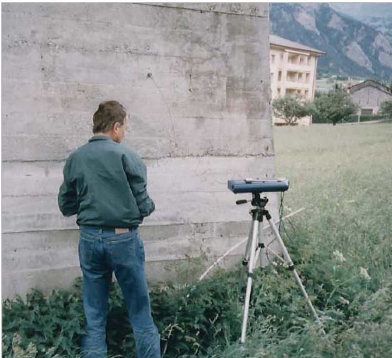
Bild 4 und 5: Messung des Körperschallschnellepegels am Brückenpfeiler
