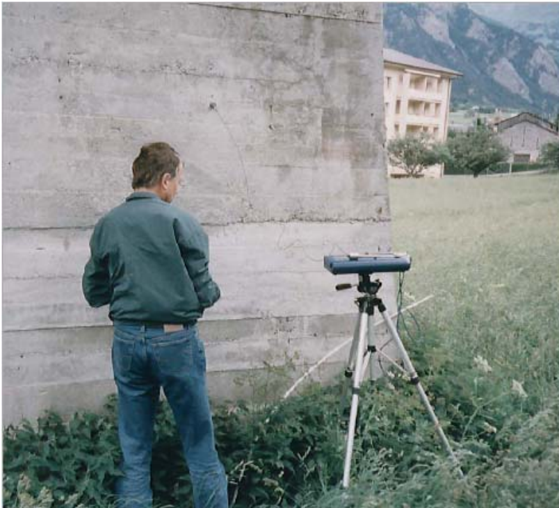
Ill. 4 et 5 : Mesure du niveau de vélocité acoustique des bruits de structure au niveau d'une pile de pont
